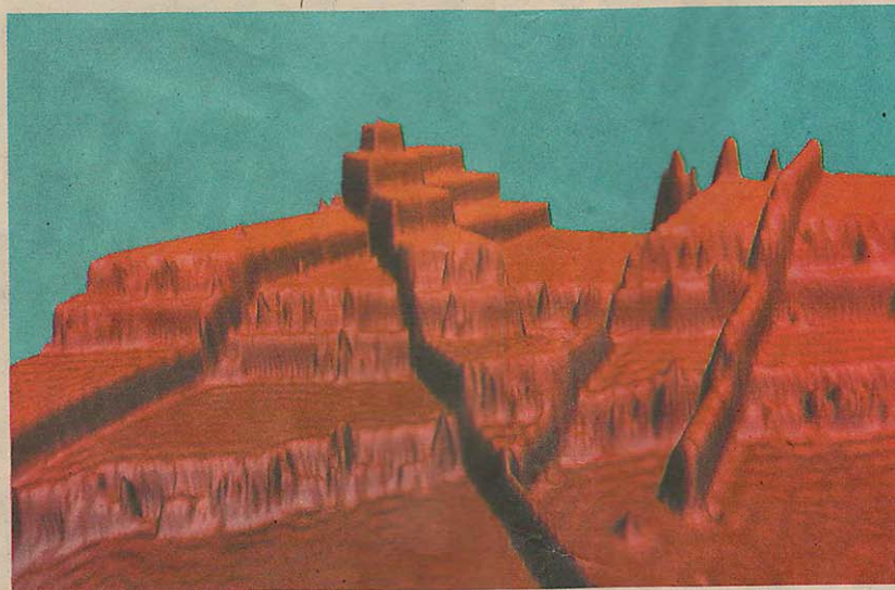
Nella monument valley del rame. La natura ondulatoria degli elettroni di un atomo di rame come appare da uno scanning tunneling microscope (Stm)
